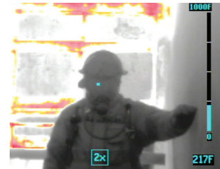
En cas d'activation du zoom numérique 2x sur la même image, apparition de l'imagerie basse sensibilité sur l'écran de la caméra E5200HD2
